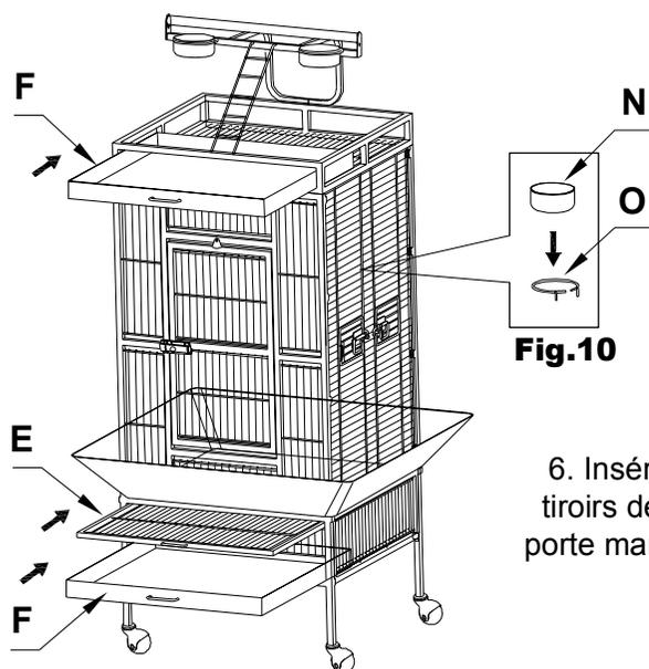
6. Insérer la grille inférieure et les tiroirs de déjection. Positionner les porte mangeoires et les mangeoires.
