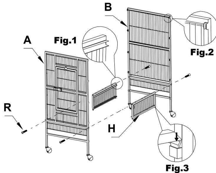
2. Emboîter les grilles latérales inférieures avec les panneaux A et B les fixer avec les vis longues .
