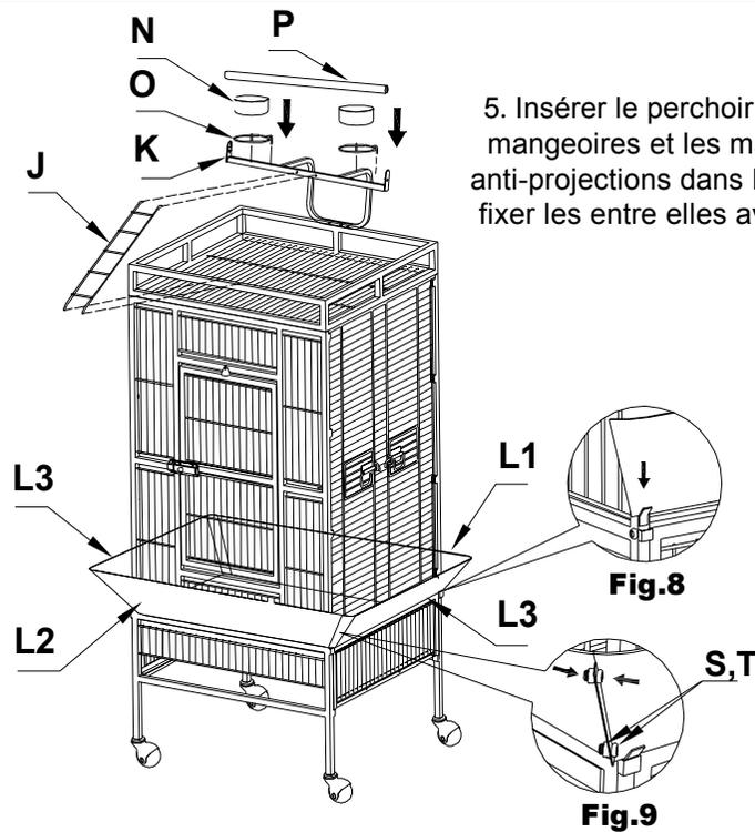
5. Insérer le perchoir extérieur, l'échelle, les porte mangeoires et les mangeoires. Insérer les bordures anti-projections dans les fentes prévues à cet effet et fixer les entre elles avec les vis courtes et les écrous.
