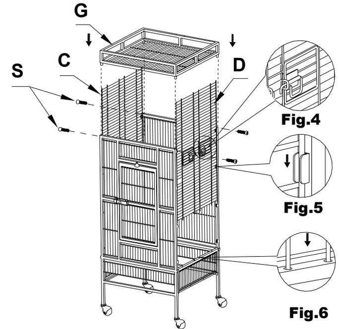
3. Insérer les grilles latérales dans les barres de guidage comme indiqué. Aligner la grille de toit dans les trous correspondants. Fixer les grilles avec les vis courtes.
